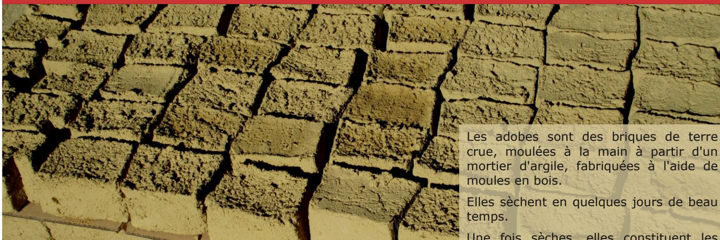
Les adobes sont des briques de terre crue, moulées à la main à partir d'un mortier d'argile, fabriquées à l'aide de moules en bois.
