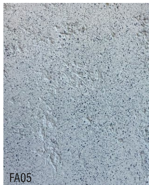
FA05 1 vol argile blanche + 2 vol poudre de marbre noire + 1 vol poudre de marbre verte
