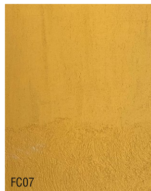
FC07 Mortier fin à la chaux prêt à l'emploi + 10 % oxyde jaune
