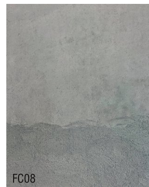
FC08 Mortier fin à la chaux prêt à l'emploi + 10 % noir indien
