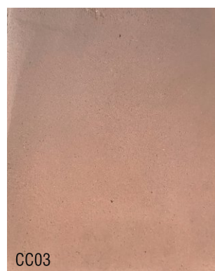
CC03 1 vol chaux aérienne en poudre + 3 vol brique pilée 0-2
