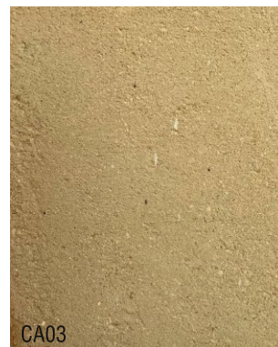
CA03 1 vol argile jaune + 3 vol sable roulé 0-4 + 10 % ombre naturelle
