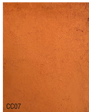
CC07 Chaux aérienne en pâte 1 vol + 5 vol sable roulé 0-4 + 15% oxyde orange
