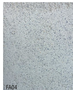
FA04 1 vol argile blanche + 2 vol poudre de marbre jaune + 1 vol poudre de marbre noire
