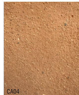
CA04 1 vol argile jaune + 3 vol sable roulé 0-4 + 10 % ocre rouge foncé
