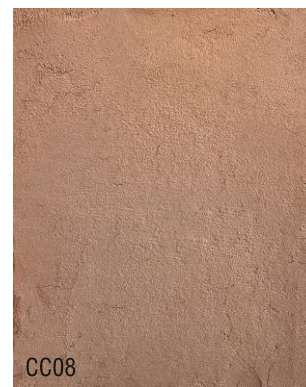
CC08 Chaux aérienne en pâte 1 vol + 5 vol sable roulé 0-4 + 15% sienne calciné
