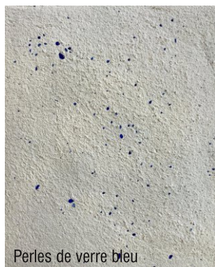
Perles de verre bleu 10 l préformulé ivoire (FA11) + 50 g perles de verre bleu
