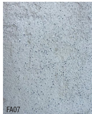
FA07 1 vol argile blanche + 2 vol poudre de marbre blanche + 1 vol poudre de marbre noire
