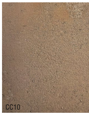
CC10 Chaux aérienne en pâte 1 vol + 5 vol sable roulé 0-4 + 15% ombre calciné
