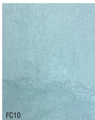
FC10 Mortier fin à la chaux prêt à l'emploi + 10 % vert M.C.
