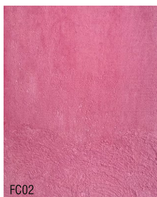
FC02 Mortier fin à la chaux prêt à l'emploi + 10 % rouge porto
