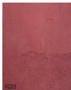
FC03 Mortier fin à la chaux prêt à l'emploi + 10 % rouge rouge
