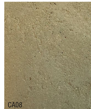
CA08 1 vol argile jaune + 3 vol sable roulé 0-4 + 10 % ocre grise
