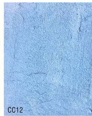
CC12 Chaux aérienne en pâte 1 vol + 5 vol sable roulé 0-4 + 15% bleu lavande
