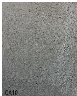
CA10 1 vol argile noire + 3 vol sable roulé 0-4
