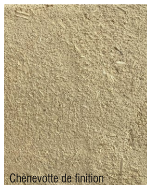
Chênevotte de finition 10 l préformulé vanille (FA18) + 100 g chênevotte de finition
