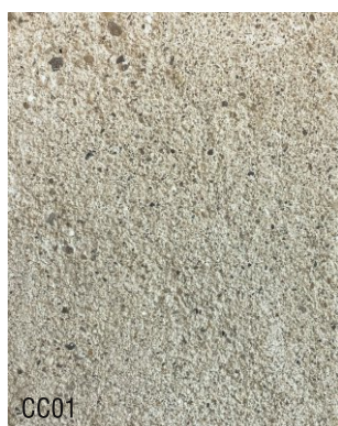
CC01 1 vol chaux aérienne en poudre + 3 vol sable de roulé 0-4
