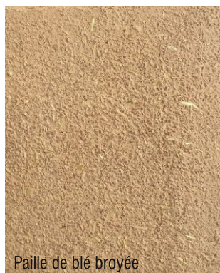
Paille de blé broyée 10 l préformulé rose tendre (FA15) + 100 g paille broyée
