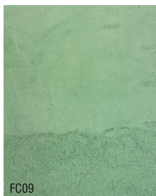
FC09 Mortier fin à la chaux prêt à l'emploi + 10 % vert pistache
