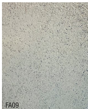
FA09 0,5 vol argile blanche + 0,5 vol argile jaune + 2 vol poudre de marbre blanche + 1 vol poudre de marbre noire
