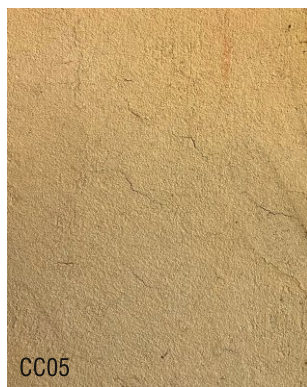
CC05 Chaux aérienne en pâte 1 vol + 5 vol sable roulé 0-4 + 15% ocre jaune foncé
