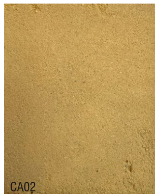
CA02 1 vol argile jaune + 3 vol sable roulé 0-4 + 10 % ocre jaune foncé
