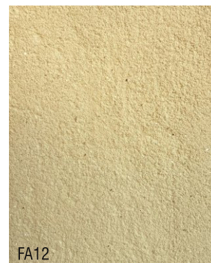
FA12 0,5 vol argile blanche + 0,5 vol argile jaune + 3 vol poudre de marbre blanche
