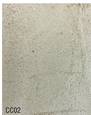
CC02 1 vol chaux aérienne en poudre + 4 vol sable blanc 0-3
