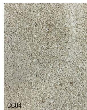
CC04 1 vol chaux aérienne en poudre + 3 vol sable jaune 0-4
