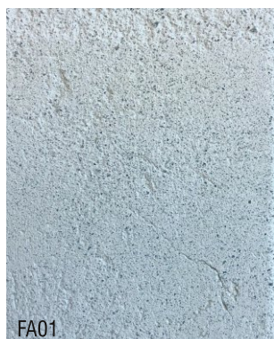
FA01 1 vol argile blanche + 3 vol poudre de marbre verte
