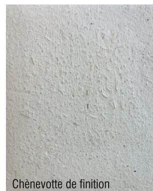
Chênevotte de finition 10 l préformulé ivoire (FA11) + 100 g chênevotte de finition
