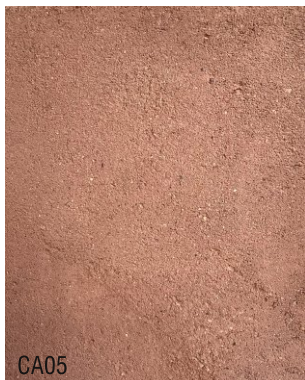
CA05 1 vol argile jaune + 3 vol sable roulé 0-4 + 10 % prune
