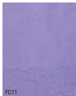
FC11 Mortier fin à la chaux prêt à l'emploi + 10 % violet outremer
