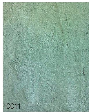
CC11 Chaux aérienne en pâte 1 vol + 5 vol sable roulé 0-4 + 15% vert pistache
