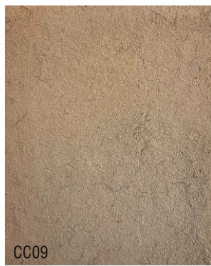
CC09 Chaux aérienne en pâte 1 vol + 5 vol sable roulé 0-4 + 15% ocre marron
